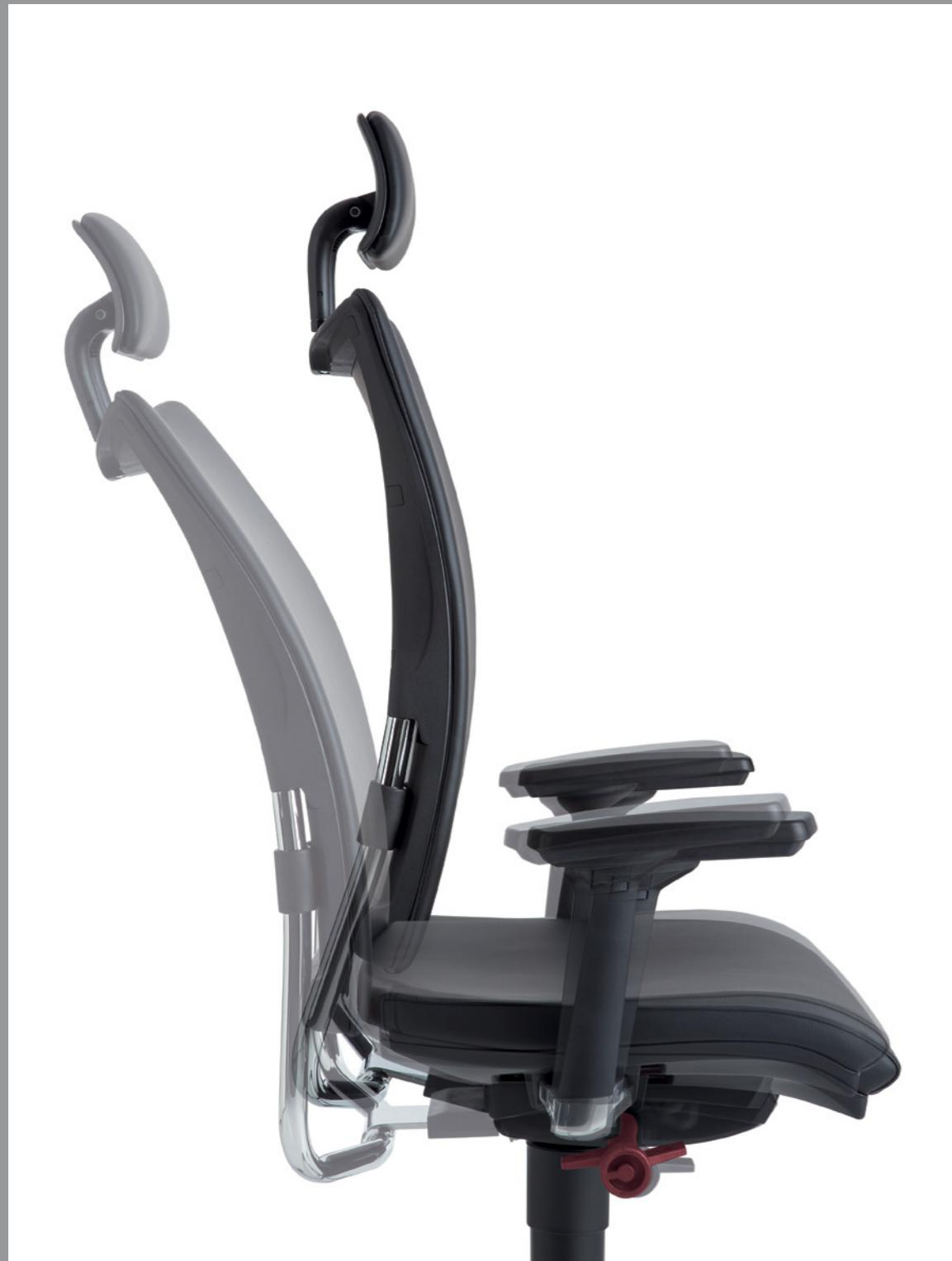
1. Meccanismo con movimento sincronizzato di sedile e schienale con 23° di oscillazione dello schienale e 7,7° di oscillazione sedile. Sei funzioni di blocco, sblocco e antishock/ Synchronized movement seat and backrest mechanism with 23° oscillation of the backrest and 7.7° oscillation of the seat. Six functions including locking, unlocking and anti-shock.
